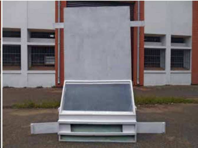
Séchoir solaire indirect
