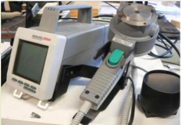
Appareil de mesure : spectrophotomètre
